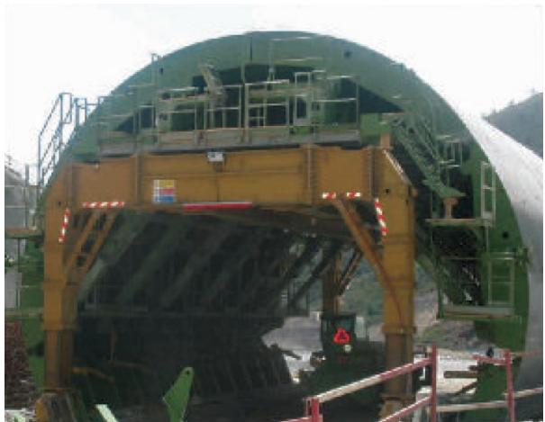
**ČELIČNE OPLATE** za beton korsite se za izgradnju putnih tunela, željezničkih tunela, hidrotunela, niskopa, podzemnih objekata i slično. Izrađujemo ih prema vlastitoj projektnoj dokumentaciji ili dokumentaciji kupaca.
